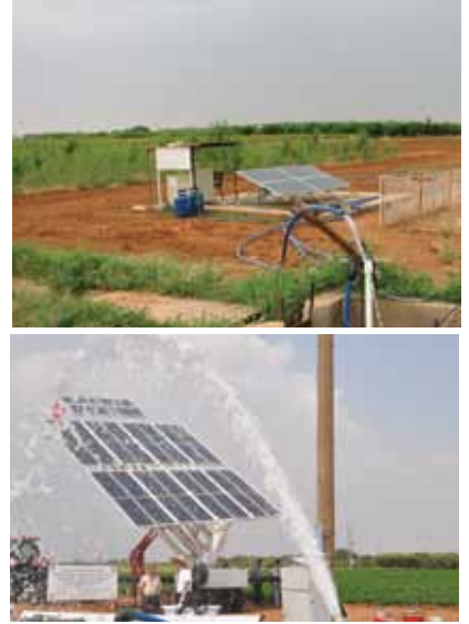
Şekil 4.1. Sabit PV sistem (a) ile Seyyar (Mobil) Güneş Pili Sulama Sistemli Prototip Makineye (b) ait görüntüler
